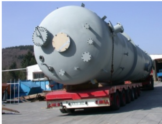
Messrs Tecnimont Material= P355NH \text{\O} = 3.000 / L = 17.080 / \text{kg} = 24.000
